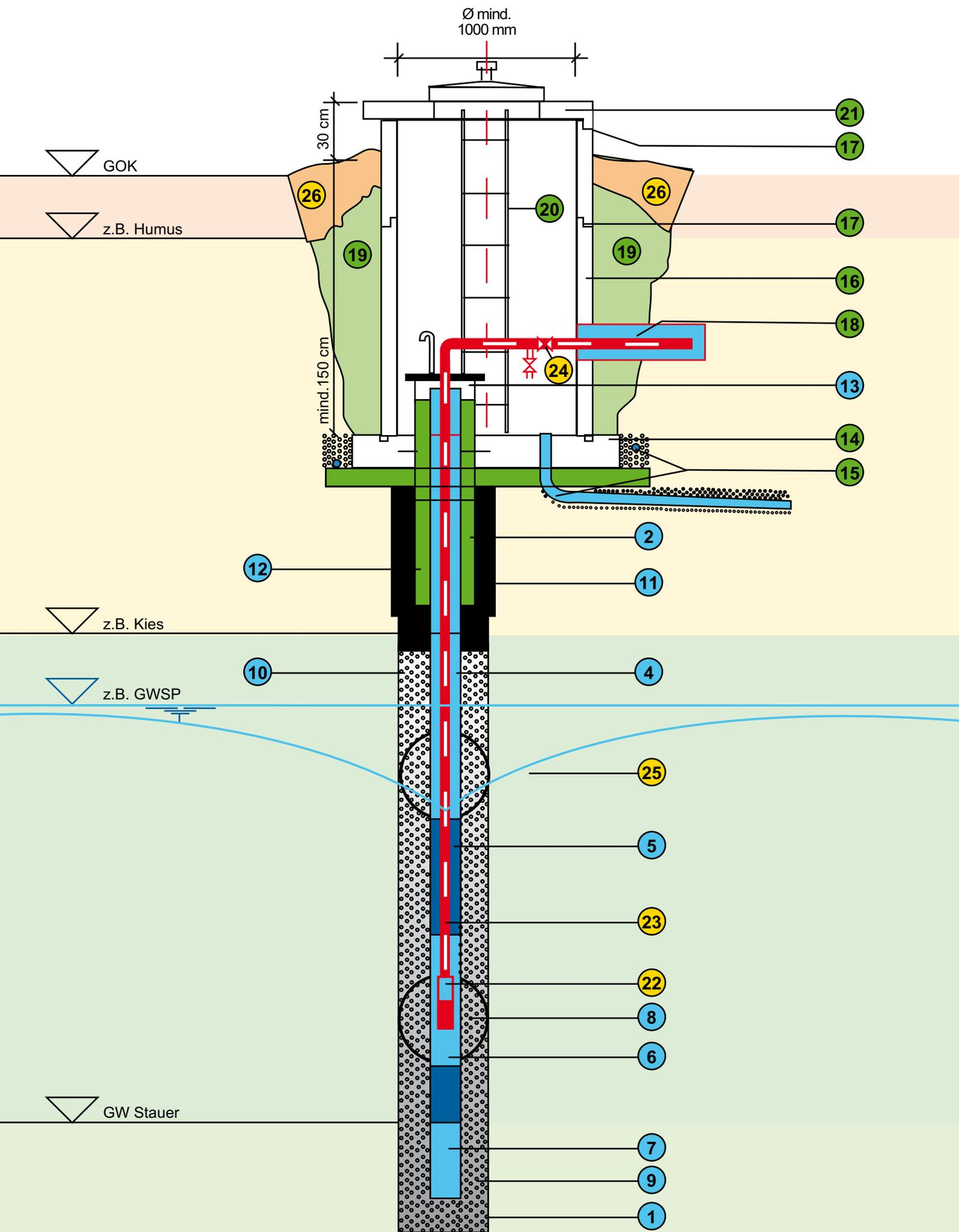
Aufbau eines Bohrbrunnens
